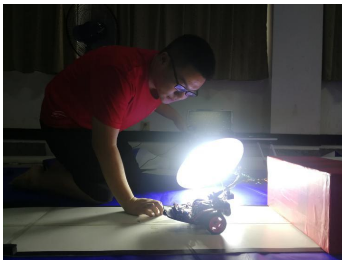
用强光测试激光测距模块对光照的适应性
